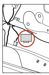
5. Установить блок в подготовленное место на кузове автомобиля.
